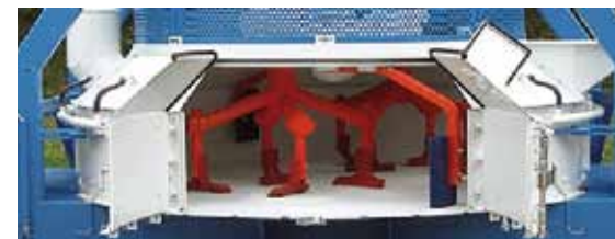
Рис. 8. Смеситель серии SM Schlosser-Pfeiffer
